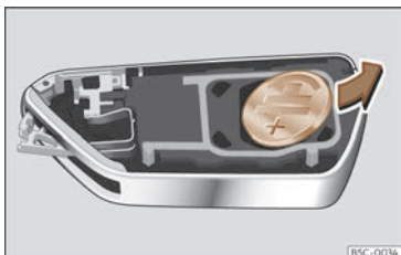
Afb. 69 Autosleutel: batterij verwijderen.
