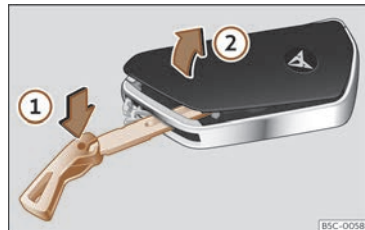
Afb. 68 Autosleutel: deksel van batterijvak openen.
