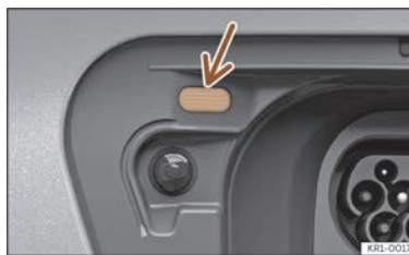
Afb. 61 Achter de acculaadklep: indicator van het laadproces.
