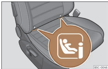
Afb. 40 Bijrijdersstoel: locatie van de i-Size-bevestigingsbeugels.
