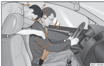
Afb. 21 De niet-vastgegespte passagier op een zitplaats achterin vliegt naar voren op de vastgegespte bestuurder.
