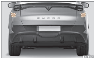
Afb. 119 Achteraanzicht van de wagen: zones van de radarsensoren.
