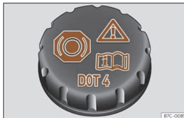
Afb. 208 Voorruiimte: dop van het remvloeistofreservoir.
