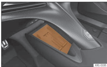
Afb. 168 In de middenconsole: steun voor het aansluiten van de mobiele telefoon.
