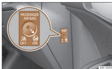
Afb. 29 Sleutelschakelaar voor het in- en uitschakelen van de bijrijdersairbag.
