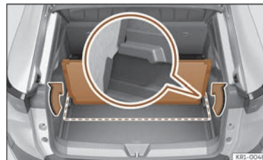
Afb. 176 In de bagageruimte: de tweede bodem van de bagageruimte vastzetten.
