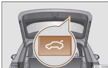
Afb. 81 Achterklep: knop om klep te sluiten.
