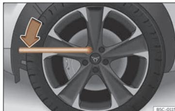
Afb. 215 Wiel verwisselen: wielbouten losdraaien.
