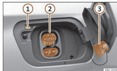
Afb. 60 Achter de laadklep van de accu, rechtsachter: laadcontactdoos.
