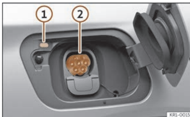
Afb. 58 Achter de laadklep van de accu, rechtsachter: Laadcontactdoos.
