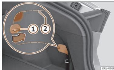
Afb. 63 Rechtsonder aan de bekleding van de bagageruimte: afdekking met snijlijnen.
