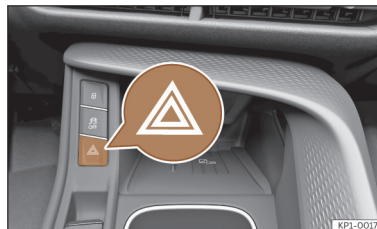
Afb. 48 Middenconsole: schakelaar voor alarmlichten.
