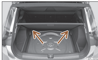
Afb. 188 Verstelbare bodem van de bagageruimte: schuine stand.
