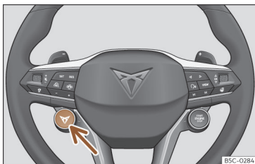
Afb. 121 Multifunctiestuurwiel: knop om het rijprofiel te wisselen.
