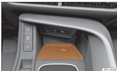
Afb. 181 In de middenconsole: steun voor het aansluiten van de mobiele telefoon.
