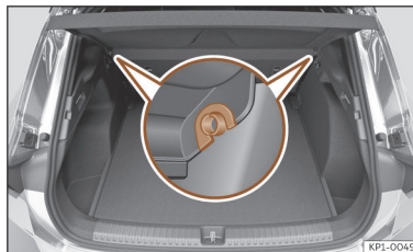
Afb. 183 In de bagageruimte: hoedenplank uit- en inbouwen.
