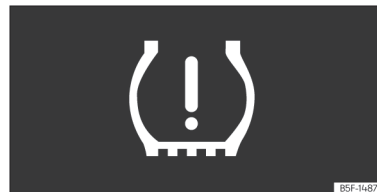
Afb. 246 Instrumentenpaneel: waarschuwing verlies van bandenspanning.
