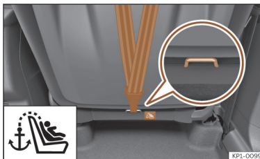
Afb. 44 Achterzijde van de rugleuning van de bijrijdersstoel: verankerung voor de Top Tether-riem (niet in alle markten/versies beschikbaar).
