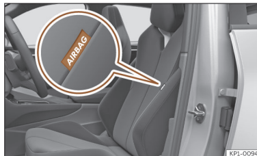
Afb. 34 Zij-airbag in de bestuurdersstoel.
