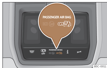
Afb. 31 In de dakconsole: controlelampje van uitschakeling bijrijdersairbag.
