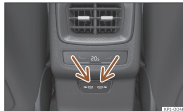
Afb. 175 Achterzijde middenconsole: USB-aansluitingen met functie van stroomvoorziening.
