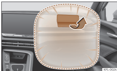
Afb. 29 Bijrijdersairbag in het dashboard.
