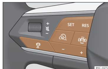
Afb. 134 Op het multifunctiestuurwiel: knoppen voor bediening van ACC.
