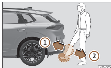
Afb. 85 Achterklep sensorgestuurd openen (Easy Open).
