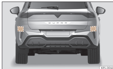
Afb. 127 Achteraanzicht van de wagen: zones van de radarsensoren.
