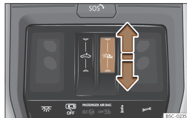
Afb. 90 In de hemelbekleding: bediening van het rolgordijn.
