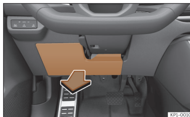
Afb. 217 In het dashboard aan bestuurderszijde: deksel van de zekeringenhouder.
