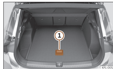
Afb. 186 Verstelbare bodem van de bagageruimte: hoge stand.
