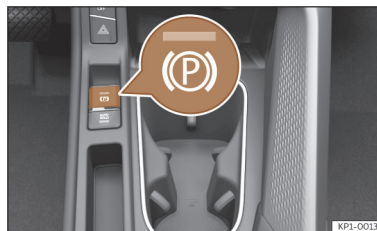
Afb. 148 Onder in de middenconsole: toets van de elektronische parkeerrem.
