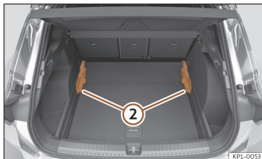
Afb. 187 Verstelbare bodem van de bagageruimte: lage stand.
