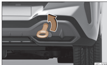
Afb. 216 Aan de rechterzijde van de achterbumper: vastgeschroefd sleepoog.
