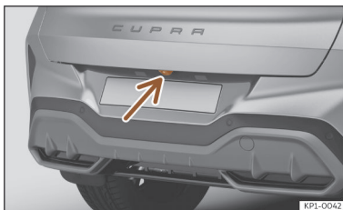
Afb. 129 In de handgreep van de achterklep: inbouwplaats van achteruitrijcamera.
