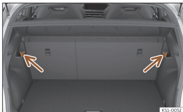
Afb. 167 In de bagageruimte: haken voor tassen.
