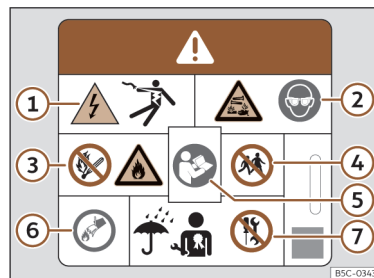
Afb. 51 Waarschuwingsschermen op de hoogvoltaccu.
