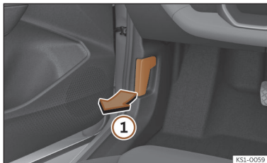
Afb. 192 Ontgrendelingshendel in de voetenruimte van de bestuurder.
