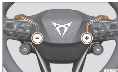
Afb. 103 Multifunctiestuurwiel: hendels voor energierecuperatie.
