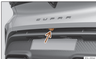
Afb. 113 In de achterbumper: inbouwplaats van achteruitrijcamera.
