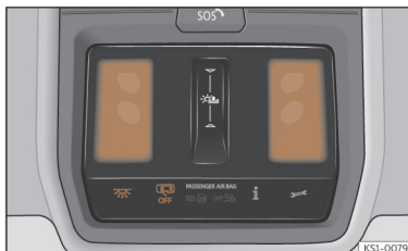
Afb. 93 Deel van de hemelbekleding: binnenverlichting voorin.
