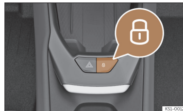
Afb. 72 In de middenconsole: knop voor centrale vergrendeling.
