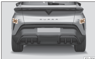
Afb. 111 Achteraanzicht van de wagen: zones van de radarsensoren.
