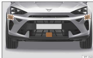
Afb. 131 In de voorbumper: radarsensoren vooraan en aan de zijkanten.
