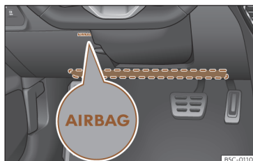
Afb. 35 Aan de bestuurderszijde: plaats van de airbag voor de knieën.
