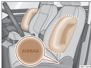
Afb. 32 Zij-airbag in de bestuurders- en bijrijdersstoel.
