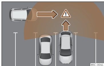
Afb. 170 Schematische voorstelling van de uitparkeerhulp: bewaakt gebied rond de wagen die een parkeerplaats verlaat
