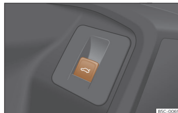
Afb. 85 In het bestuurdersportier: knop om achterklep te openen en sluiten.
