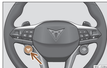
Afb. 128 Multifunctiestuurwiel: knop om het rijprofiel te wisselen.
