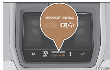
Afb. 29 In de dakconsole: controlelampje van uitschakeling bijrijdersairbag.
