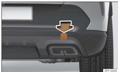
Afb. 217 Aan de rechterzijde van de achterbumper: de afdekking verwijderen.
