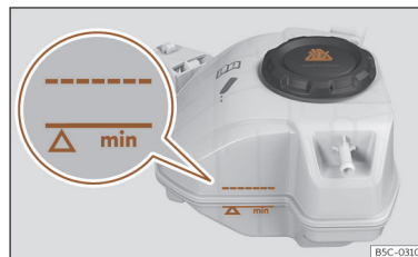
Afb. 225 In de voorruimte: koelvloeistofexpansiereservoir.
