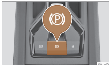
Afb. 156 Onder in de middenconsole: toets van de elektronische parkeerrem.
