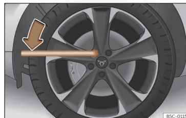
Afb. 194 Wiel verwisselen: wielbouten losdraaien.
