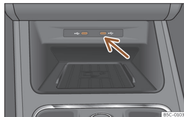
Fig. 178 Centre console: USB input.
