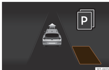
Afb. 157 Op het display van het instrumentenpaneel: beperkte weergave van het inparkeersysteem.
