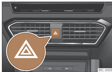
Afb. 50 Dashboard: schakelaar voor alarmlichten.
