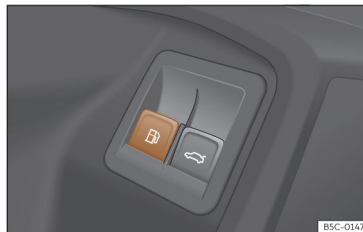
Afb. 208 Bestuurdersportier: ontgrendeling van de tankklep.
