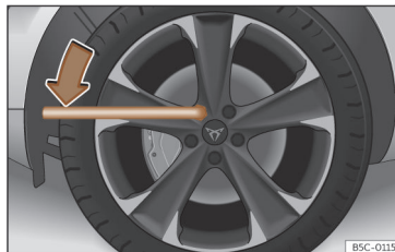
Afb. 243 Wiel verwisselen: wielbouten losdraaien.
