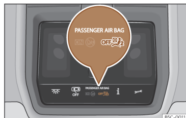
Afb. 29 In de dakconsole: controlelampje van uitschakeling bijrijdersairbag.
