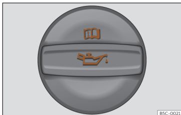
Afb. 232 In de motorruimte: dop van de motorolie-vulopening.
