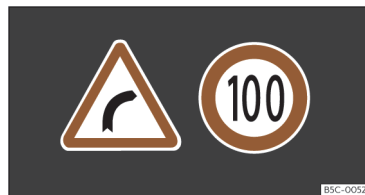
Afb. 9 In het display van het instrumentenpaneel: voorbeelden van herkende verkeerstekens.
