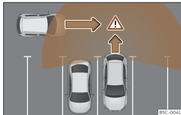
Afb. 163 Schematische voorstelling van de uitparkeerhulp: bewaakt gebied rond de wagen die een parkeerplaats verlaat
