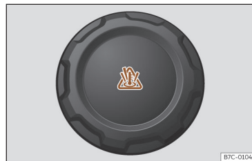
Afb. 226 Voorruimte: vuldop van het koelvloeistofexpansiereservoir.
