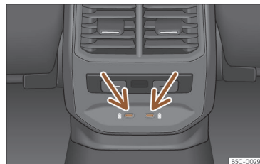
Afb. 172 Achterzijde middenconsole: USB-aansluitingen met functie van stroomvoorziening.
