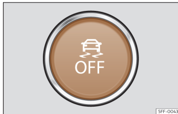
Afb. 123 Onder in de middenconsole: knop voor in-/uitschakeling van ESC.
