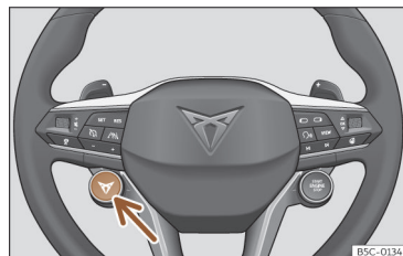
Afb. 123 Multifunctiestuurwiel: knop om het rijprofiel te wisselen.
