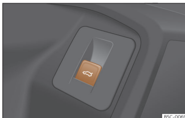
Afb. 81 In het bestuurdersportier: knop om achterklep te openen en sluiten.
