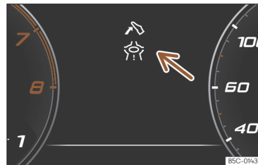
Afb. 135 Aanwijzing van het hulpsysteem voor eco-efficiënt rijden (schematische voorstelling).
