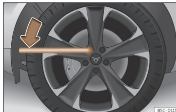
Afb. 236 Wiel verwisselen: wielbouten losdraaien.
