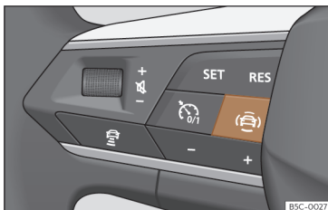
Afb. 126 Linkerzijde van het multifunctiestuurwiel: toets voor de bestuurdershulpsystemen (naargelang het model).
