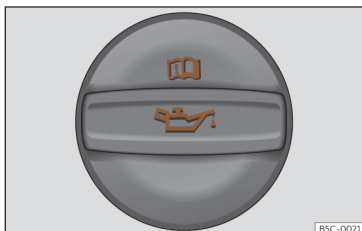
Afb. 226 In de motorruimte: dop van de motorolie-vulopening.
