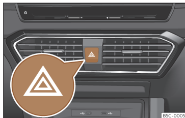
Afb. 50 Dashboard: schakelaar voor alarmlichten.
