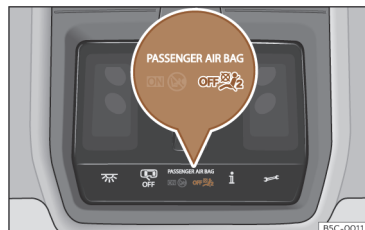
Afb. 29 In de dakconsole: controlelampje van uitschakeling bijrijdersairbag.
