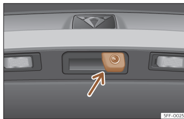
Afb. 132 In de handgreep van de achterklep: inbouwplaats van achteruitrijcamera.
