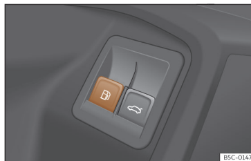
Afb. 202 Bestuurdersportier: ontgrendeling van de tankklep.
