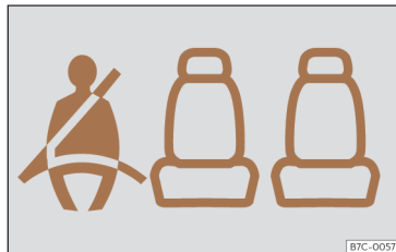
Afb. 19 Instrumentenpaneel: indicatie van de staat van de veiligheidsgordels voor de zitplaatsen achterin.
