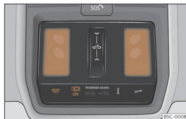
Afb. 106 Deel van de hemelbekleding: binnenverlichting voorin.
