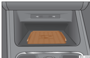
Afb. 182 In de middenconsole: steun voor het aansluiten van de mobiele telefoon.
