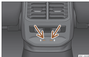
Afb. 176 Achterzijde middenconsole: USB-aansluitingen met functie van stroomvoorziening.
