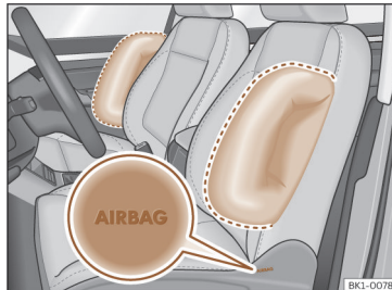
Afb. 32 Zij-airbag in de bestuurders- en bijrijdersstoel.
