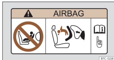
Afb. 38 Airbagsticker: op de zonneklep aan bijrijderszijde.
