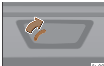
Afb. 84 Deel van de bagageruimte: noodontgrendeling.
