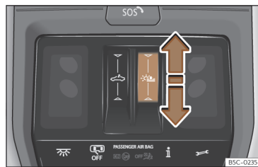
Afb. 88 In de hemelbekleding: bediening van het rolgordijn.
