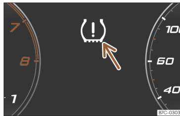
Afb. 239 Instrumentenpaneel: waarschuwing verlies van bandenspanning.
