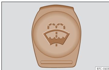
Afb. 222 In de voorruimte: blauwe dop van het ruitensproeiervloeistofreservoir.
