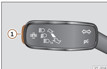
Afb. 125 Knipperlicht- en grootlichthendel: toets voor de bestuurdershulpsystemen (naargelang het model).
